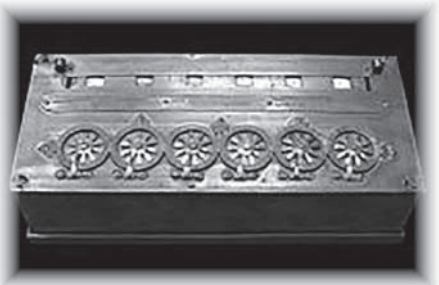
Die von Pascal erfundene Rechenmaschine „Pascaline“
